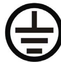
Imagen 29 Toma de tierra
