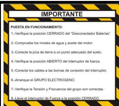
Imagen 21 Puesta en funcionamiento
