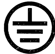
Imagen 24 - Toma de tierra
