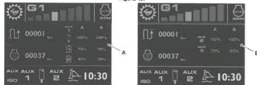
A Aux 1 (caudal alto) - estado de porcentaje de caudal máximo
