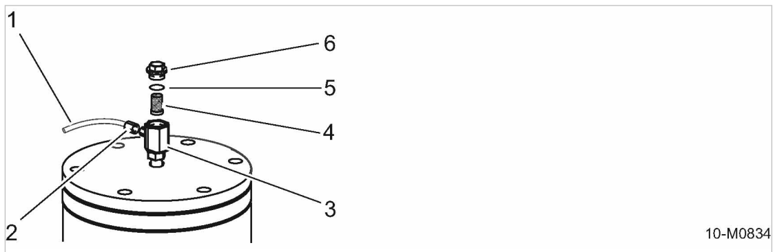
Fig. 44 Mantenimiento del colector de suciedad del depósito separador de aceite
