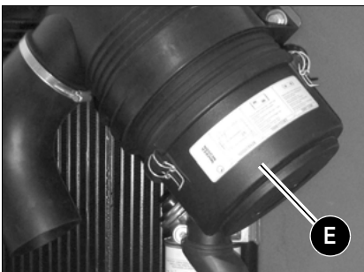
Fig. 24: Desmontaje de la parte inferior de la caja
