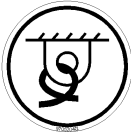
Fig. 8: Señal de puntos de amarre de la cabina
