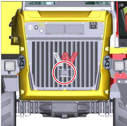
Fig. 137: Sensor ASC unidad de accionamiento (opción)
