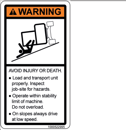
Fig. 66: Riesgo de vuelco
