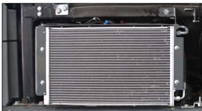
Fig. 245: Condensador de climatización
