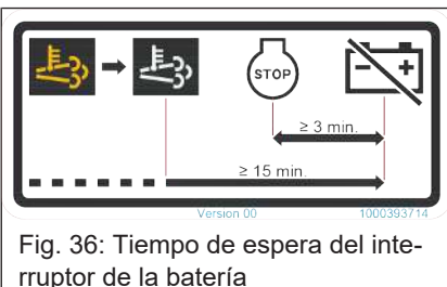
Fig. 35: Tiempo de espera del interruptor de la batería
