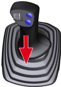
Fig. 183: Descenso de emergencia de la palanca de mando
