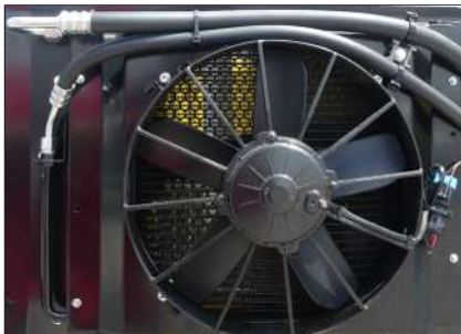
Fig. 253: Condensador de climatización
