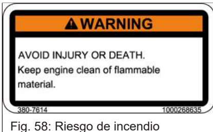
Fig. 58: Riesgo de incendio
