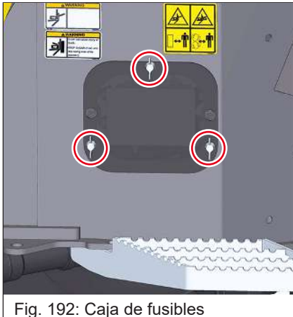
Fig. 192: Caja de fusibles
