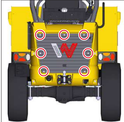
Fig. 252: Rejilla de ventilación (representación simbólica)
