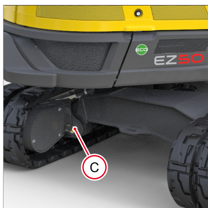
Fig. 248: Cáncamos de amarre en el mecanismo de traslación, interior
