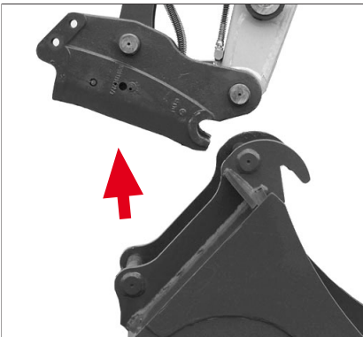
Fig. 212: Depositar el equipo adosado
