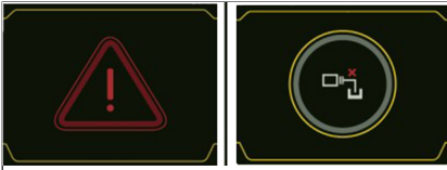
Fig. 183: AUX, advertencia de descarga de presión
