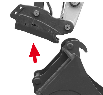
Fig. 219: Depositar el equipo adosado
