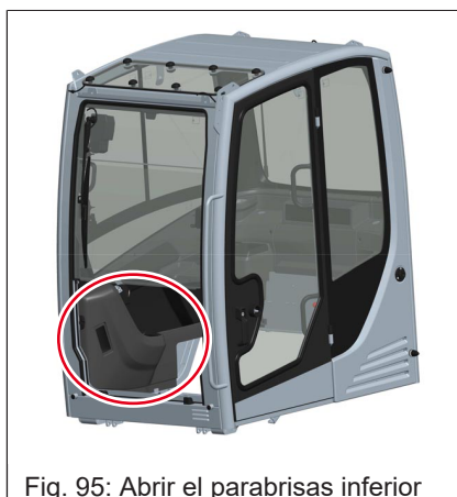
Fig. 95: Abrir el parabrisas inferior
