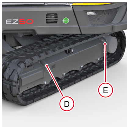
Fig. 249: Cáncamo de amarre en el mecanismo de traslación, exterior
